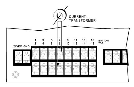
NOTE: PICTURE SHOWS CONNECTION FOR MODULE IN POSITION 1 ON ANALOG BRICK.
