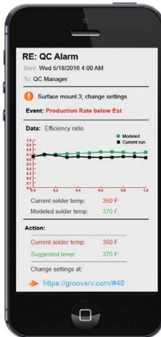
ajuste de la temperatura de la soldadura de la máquina, e ingresó el valor recomendado.
